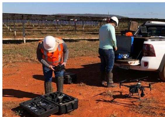
Operator mengidentifikasi hampir 6.000 anomali-anomali penyebab pengurangan profitabilitas di seluruh lokasi, dengan masalah mulai dari panel surya yang rusak dan cacat pada dioda bypass hingga kerusakan sel surya dan akumulasi jumlah kotoran pada panel.
